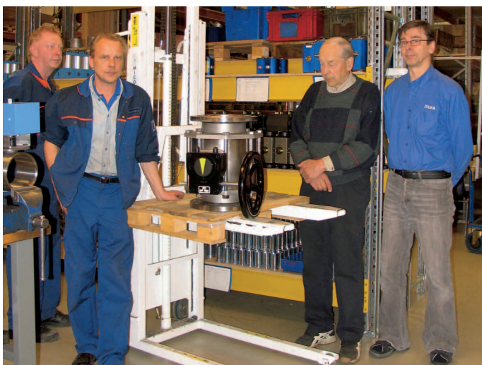
KUVASSA JOUKAN UUTUUS DN 200. VENTTIILILLÄ ON PAINOA KOMEAT 115 KG. KÄSIVAIHDE TAKAA HELPON KÄYTETTÄVYYDEN.
