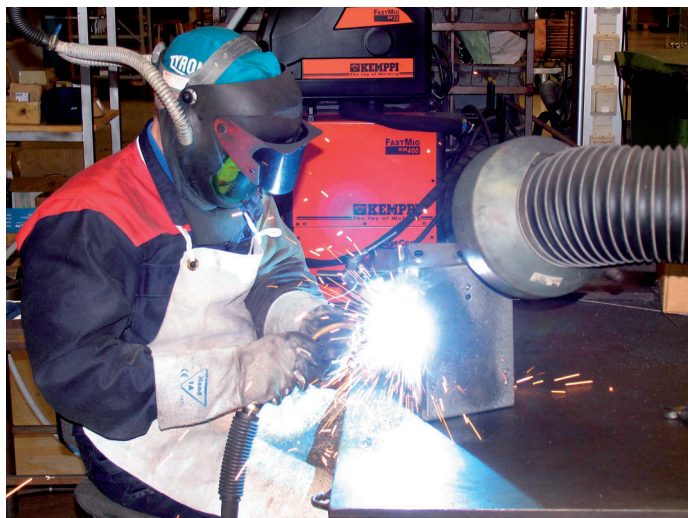
MAG HITSAUKSELLE SAADAAN TEHOA, MUTTA YLEISEMPI TITAANIN HITSAUSMENETELMÄ ON TIG, JOLLA VOIDAAN PAREMMIN VÄLTÄÄ HUOKOISUUSRISKIT. HITSAUS TAPAHTUU TÄYDELLISESSÄ SUOJAKAASUSSA..
