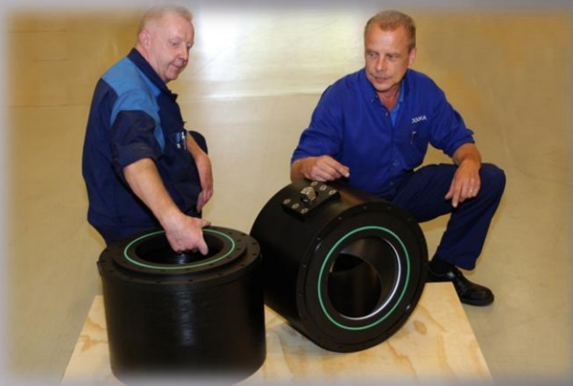
Пластиковые вентиля на DN 250 по Специальному заказу для морского круизного судна, по проекту фирмы Baltic Yacht
