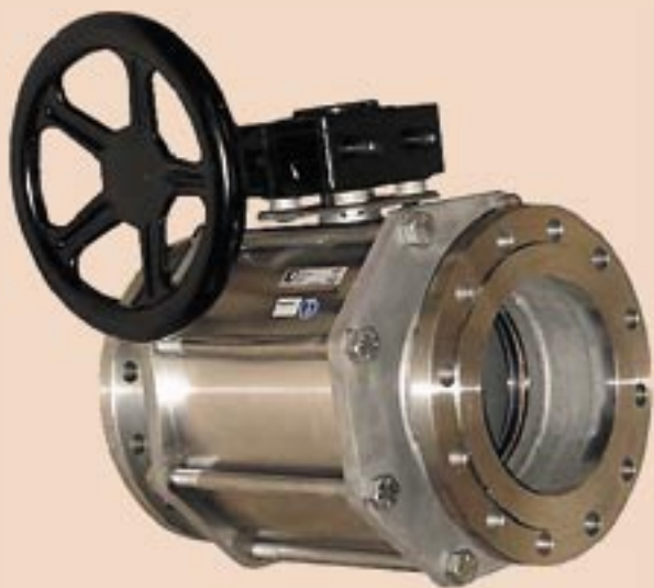
DN 200 med full genomlopp, hårdkromad kula och metal kultätningar. Höga temperaturer och slitande material.
